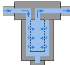
Filtre en ligne F-MI1-T avec surveillance des filtres
