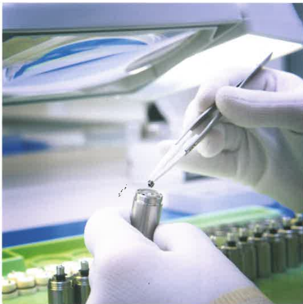
Les tolérances de fabrication des rotors se situent dans la plage de quelques micromètres, ce qui confère aux pompes m2r une grande précision
