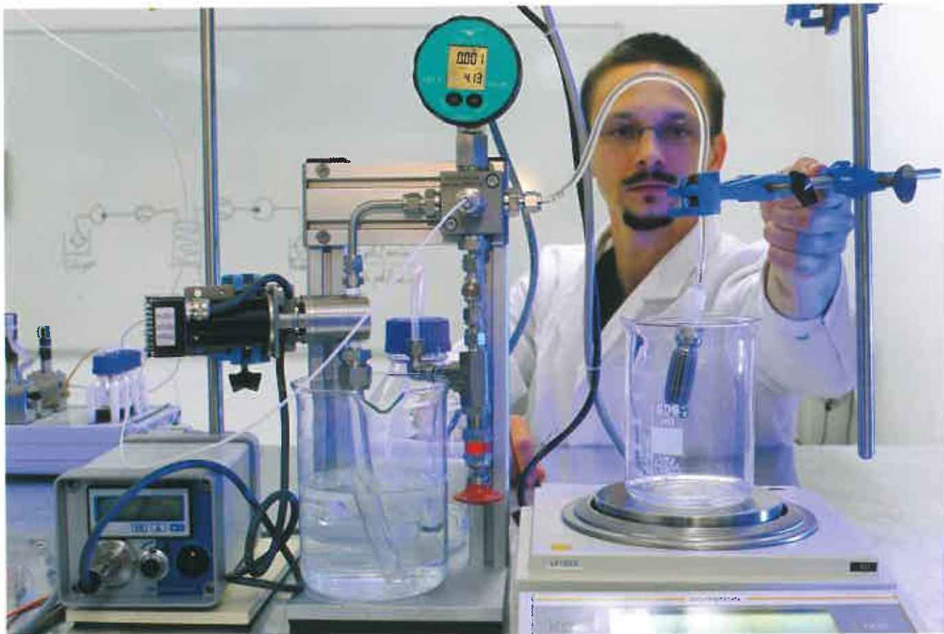
Ces pompes génèrent un débit homogène et constant, de très faibles pulsations et tensions de cisaillement.
