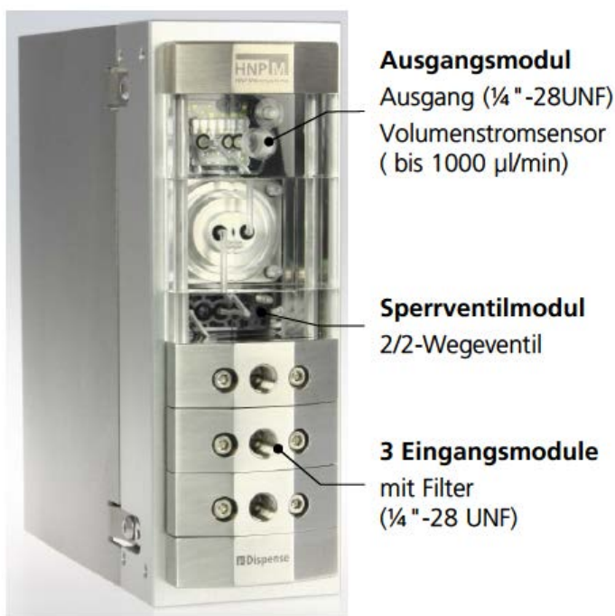
Bild 4 Ansicht Beispiel µDispense® (3 Eingangsmodulen, Pumpenmodul, Ausgangsmodul)
