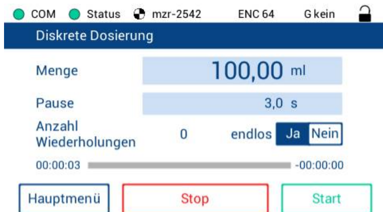
Grafische Bedienoberfläche des mZR-Touch Control für die diskrete Dosierung Bild: hnpm_mZR-Touch Control_Dosierung.jpg
