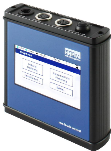
mZR-Touch Control zur grafische Ansteuerung von Dosierpumpen Bild: hnpm_mZR-Touch Control.jpg
